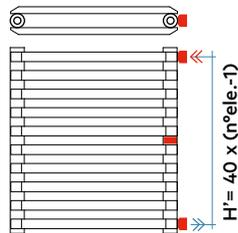
Conexiones hidráulicas soldadas
