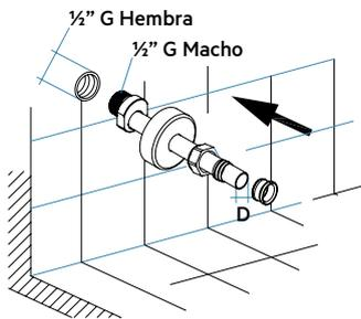
El cubretubo realiza la función de conexión y soporte por lo que para una correcta instalación se debe dejar la toma de media hembra enrasada a la pared.
